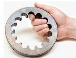
Ein XXL-Schneideisen zur Herstellung von Aussengewinden für Airbus (Fotos, auch in höherer Auflösung zum Download: Gebr. Dapprich)
