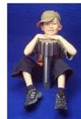
Der größte bis dato für einen Kunden hergestellte Gewindebohrer mit einem Durchmesser von 165 mm. Er diente zur Reparatur einer Hydraulikleitung bei der Ruhrkohle AG. Der Rohling dieses Werkzeuges hatte satte 70kg auf die Drehbank gebracht.
